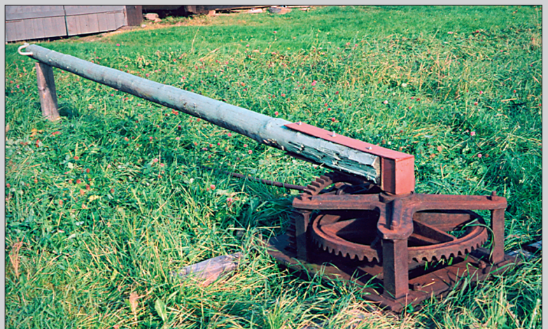
Kjørehjulet med stang på Bromoen. Hesten var festet til enden på den lange trestanga og gikk rundt i ring og dro overføringsakselen vises nede i gresset.
